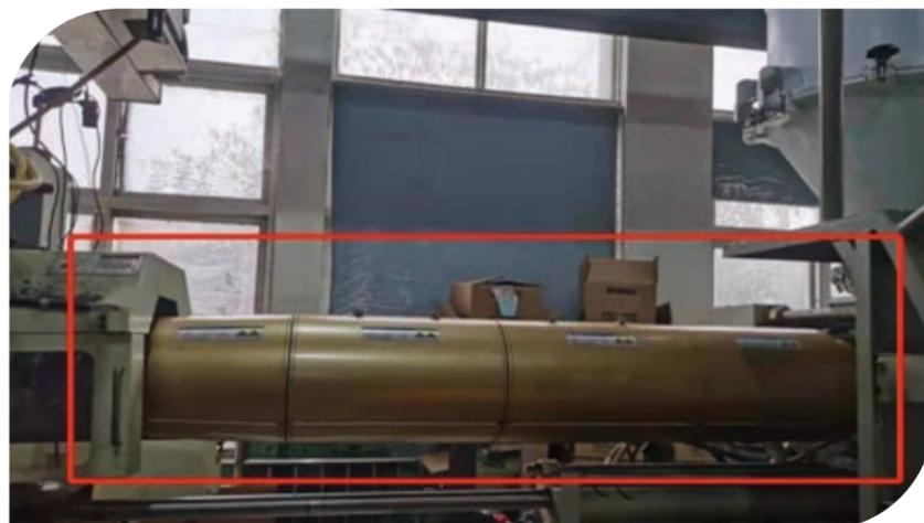
在射出成型機上安裝節能發熱圈，節約用電
